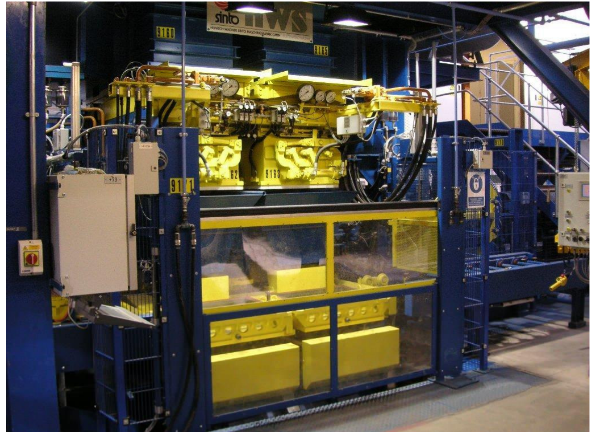
HWS-Formmaschine ZFA-SD5 mit Luftstrom- und Vielstempelpresse-einrichtung, kombiniert mit Seitsu.plus für modellseitiges Pressen.
