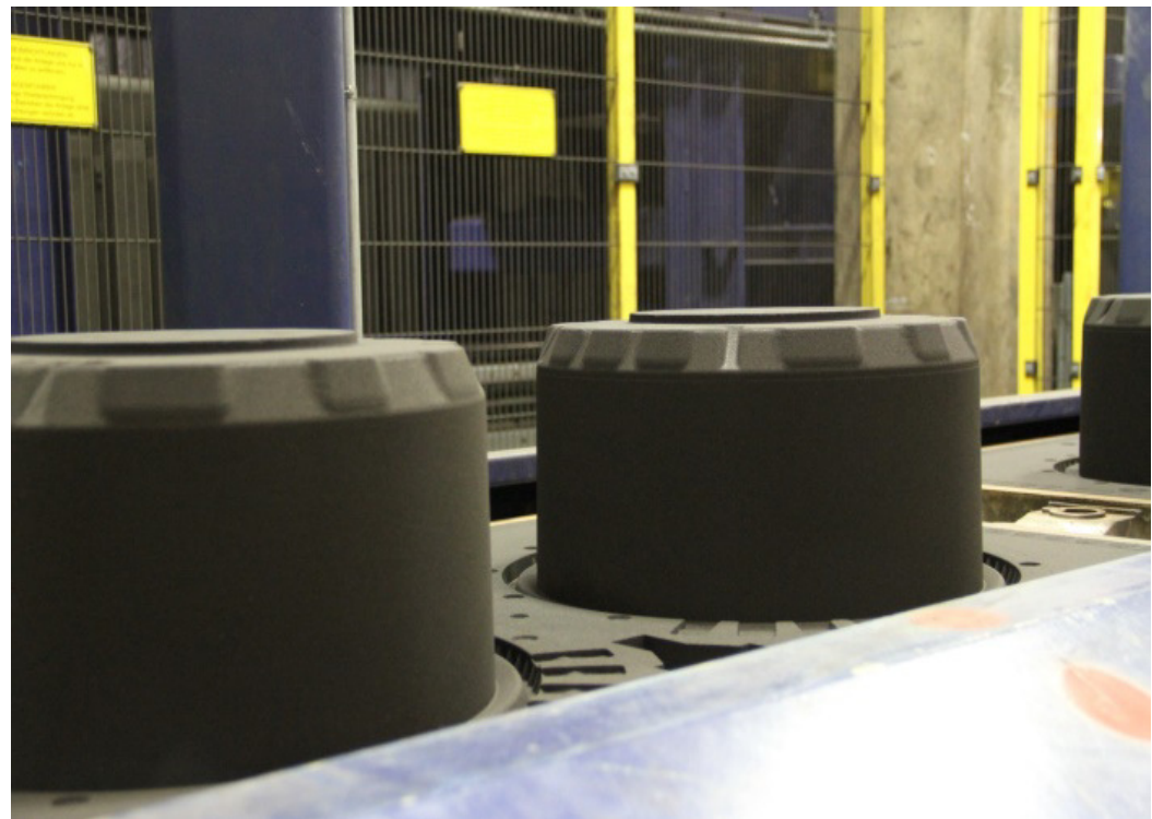
Unterkasten mit ausgeformten Ballen für Bremstrommeln
