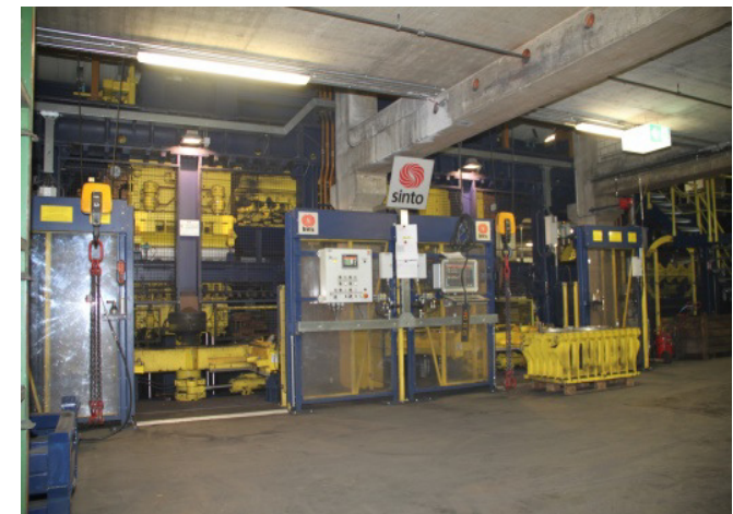
Blick auf die Einzelformmaschinen: Links Oberkasten-, rechts Unterkasten-Formautomat
