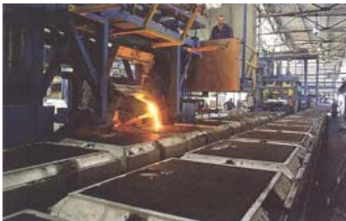
Рис.7. Заливка на автоматической формовочной линии фирмы HWS
